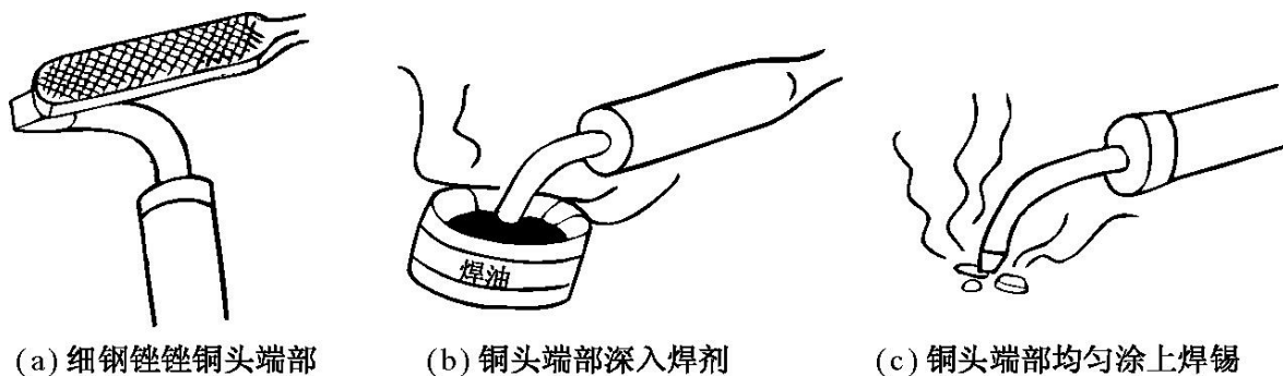
图2 电烙铁铜头上锡过程
